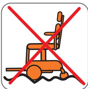
Ce fauteuil roulant est destiné à un usage intérieur uniquement et conçu pour résister à des obstacles allant jusqu'à 40 mm. Ces obstacles doivent être franchis en oblique ou perpendiculairement.
