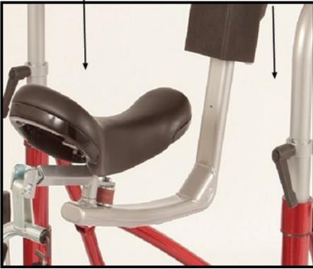
Les ressorts sont facilement interchangeables. Saisissez et ouvrez la poignée de levée pour abaisser le cadre. Les extrémités des tubes sont fermées par des caches tubes. Ouvrez les caches tubes pour retirez les ressorts. Pour les ouvrir, poussez vers le haut et tournez dans le sens des aiguilles d'une montre avant de le tirer vers le bas. Après avoir retiré les anciens ressorts, insérez les nouveaux dans les tubes.
