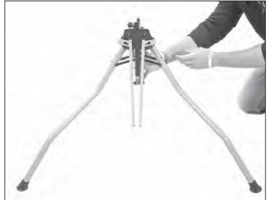
3. Verrouillez le mécanisme central en appuyant dessus pour verrouiller le bouton a ressort. Le symbole de verrouillage blanc sera visible lorsque le dispositif sera verrouillé.
