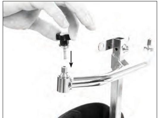
12. À l'aide de 2 vis fournies, placer le coussin de support supérieur du corps en position dorsale (avec sangle) sur le dispositif comme indiqué. Insérer 2 vis et les serrer fermement.
