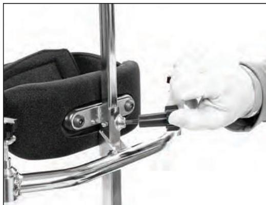
15. Retirer les 2 vis de l'appui-tête (ce dernier n'a pas de sangles). Placer le sur le support comme indiqué. Insérer 2 vis et les serrer à fond.
