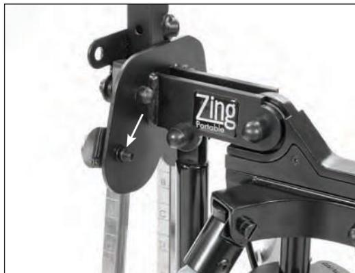
5. Retirez uniquement les rondelles en caoutchouc des deux vis et jetez-les.
