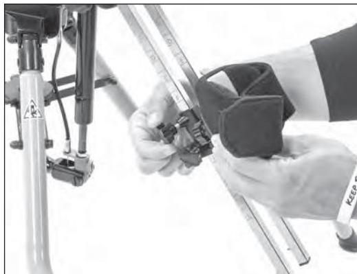
20. Appuyer sur le bouton à ressort du pied et insérer le repose-pied dans le tube comme indiqué. Mettre en position et serrer fermement. Répéter les étapes pour l'autre repose-pied.
