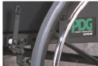
**AVERTISSEMENT:** Inspectez régulièrement l'ajustement de la position des crans d'arrêt.
