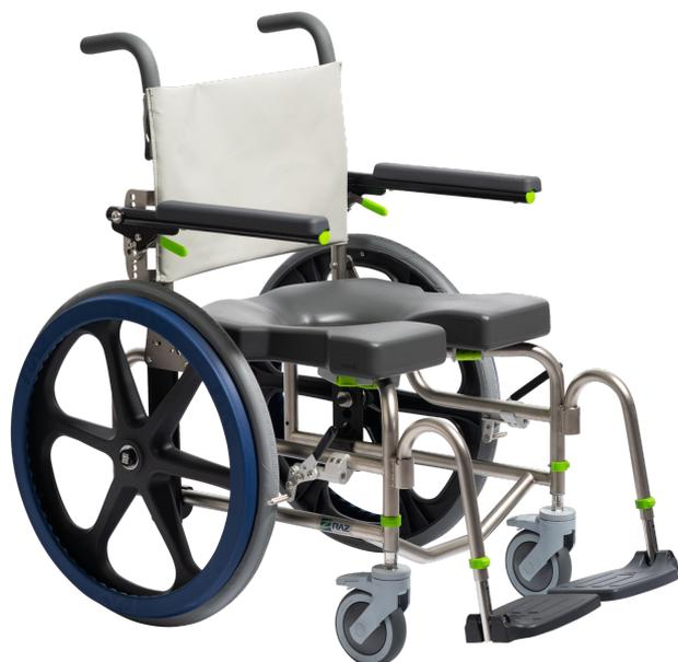
Fauteuil roulant de douche percé, équipement spécial pour handicapés. Avec cadre en acier inoxydable réglable en hauteur, supports d'accoudoirs rembourrés rabattables, supports de pieds, roues arrière de 22" ou 24", roulettes avant à double blocage de 5 pouces (125 mm) et seau amovible également permettant une utilisation dans la douche ou au dessus des toilettes. Capacité de poids de l'utilisateur : 181 Kg.
