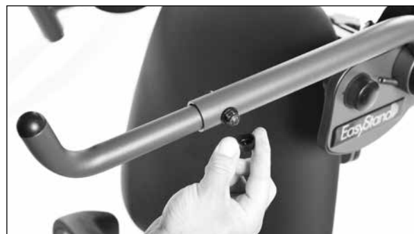
12. Tirer vers le bas le manchon de protection en tissu sur le bras d'appui pour découvrir la vis. Retirer le capuchon de protection noir du bras d'appui.
