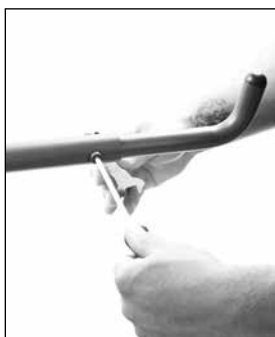
13. Retirer l'écrou et la rondelle à l'aide d'une clé hexagonale et d'une clé de 13 mm. Placer à la position souhaitée. Bien serrer à l'aide d'une clé hexagonale et d'une clé de 13 mm. Remettre en place le capuchon de protection noir sur l'écrou.
